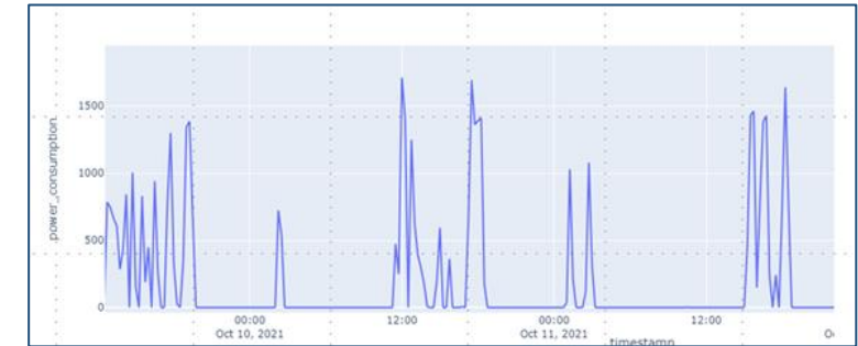
Lastprofil einer Wärmepumpe [1]
